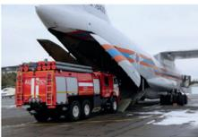
Сибирским спасателям выделили тяжёлый транспортный самолёт Ил-76 для борьбы с аварийными ситуациями и лесными пожарами. Транспорт может перевозить груз весом до 60 тонн на расстоянии 5 тысяч км. В самолёт помещаются два грузовых автомобиля и более ста человек.
